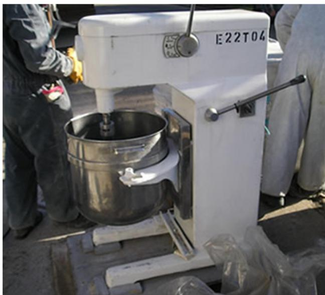
Cuando el producto a mezclar exige hacerlo con extremadamente bajos porcentajes de agua, lo recomendable es usar mezcladoras de mezcla intensiva, como lo son las mezcladoras tipo Hobart. Estas máquinas proporcionan amplio poder de la potencia sobre el material obligando a los granos a interactuar forzosamente con la poca agua existente.
